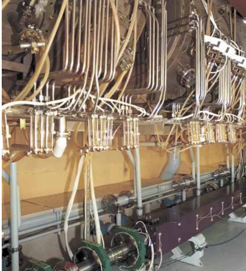
Первая очередь установки с ЛСЭ, запущенная в апреле 2003 г., в отличие от полномасштабного варианта имеет единственный канал транспортировки электронов
